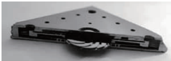
图2 MIT研制的微型燃气涡轮发动机 [7]
